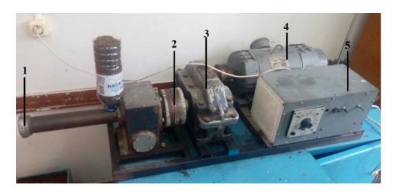
*Рисунок 1* – Экспериментальный маслопресс. 1 – матрица, 2 – муфта, 3 – редуктор, 4 – электродвигатель, 5 – частотный преобразователь.
