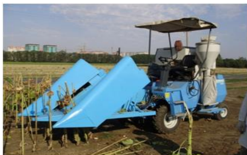
Рисунок 2 – Селекционный комбайн с жаткой для уборки подсолнечника
